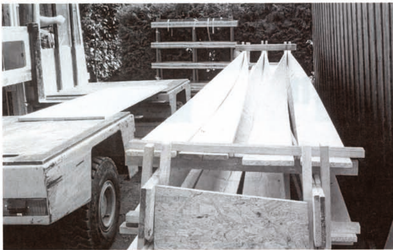
Einfach, aber effizient: die Vorrichtung (unten) für die Herstellung der verdrehten Holz-Lamellen. Foto: Kaufmann Holzbau AG
